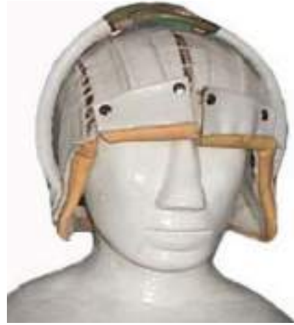
11-сурет – Адам басын салқындату үшін шлем түріндегі термоэлектрлік құрылғы
