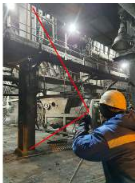
Рисунок 3 – Геодезическое определение вертикальности колонн координатным способом
