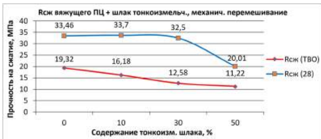
Рисунок 3 – Прочность на сжатие вяжущего ЦЩВ-Пм механически перемешанного Ц + шлак измельченный после ТВО и 28 суток нормального твердения
