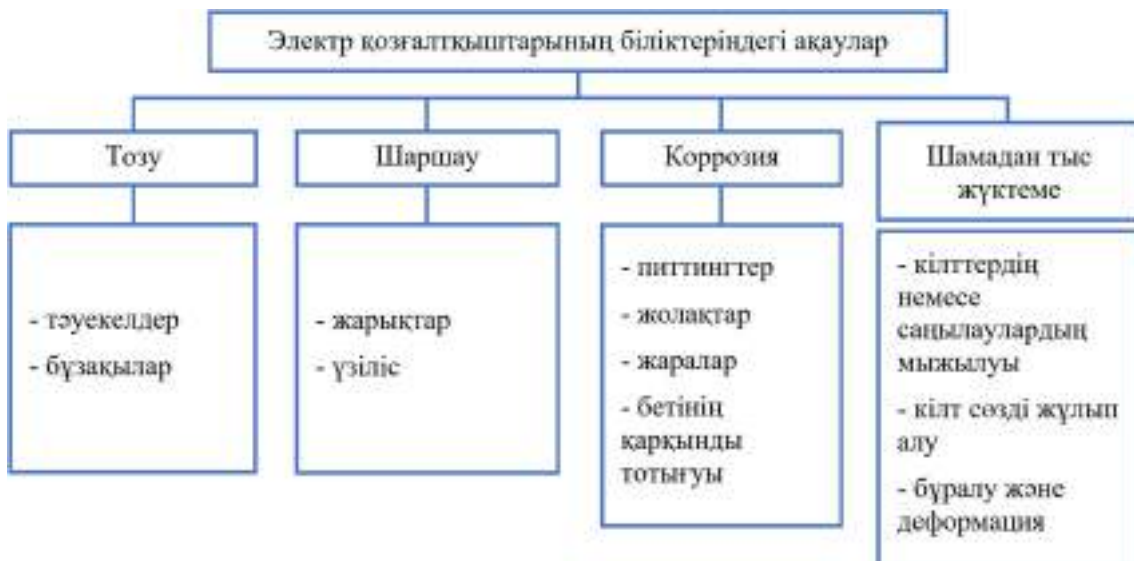
5-сурет – Электр қозғалтқыштары біліктерінің ақауларының жіктелуі
