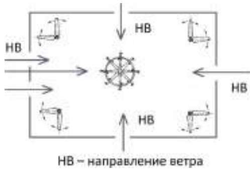
Рисунок 1 – Схема расположения ветрогенераторной установки
