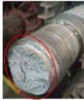
3-сурет – Шаршау салдарынан электр қозғалтқыштарының біліктерінің бұзылуы
