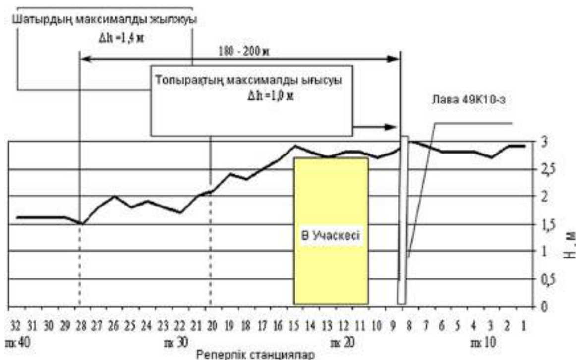
1-сурет – 49к 10-3 конвейерлік штрек деформациясының өзгеру динамикасы (в участкесі, лаваның артында ұсталады)
