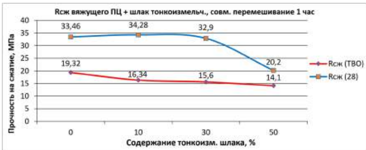
Рисунок 6 – Прочность на сжатие вяжущего ЦЩВ-Ии совместно измельченного 1 час Ц + Шлак тонкоизмельченный после ТВО и 28 суток нормального твердения
