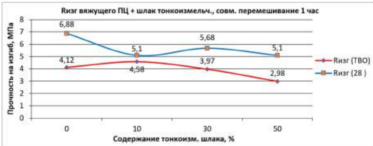
Рисунок 5 – Прочность на изгиб вяжущего (Ц + Шлак тонкоизмельченный) ЦЩВ-Ии совместно измельченного 1 час после ТВО и 28 суток нормального твердения
