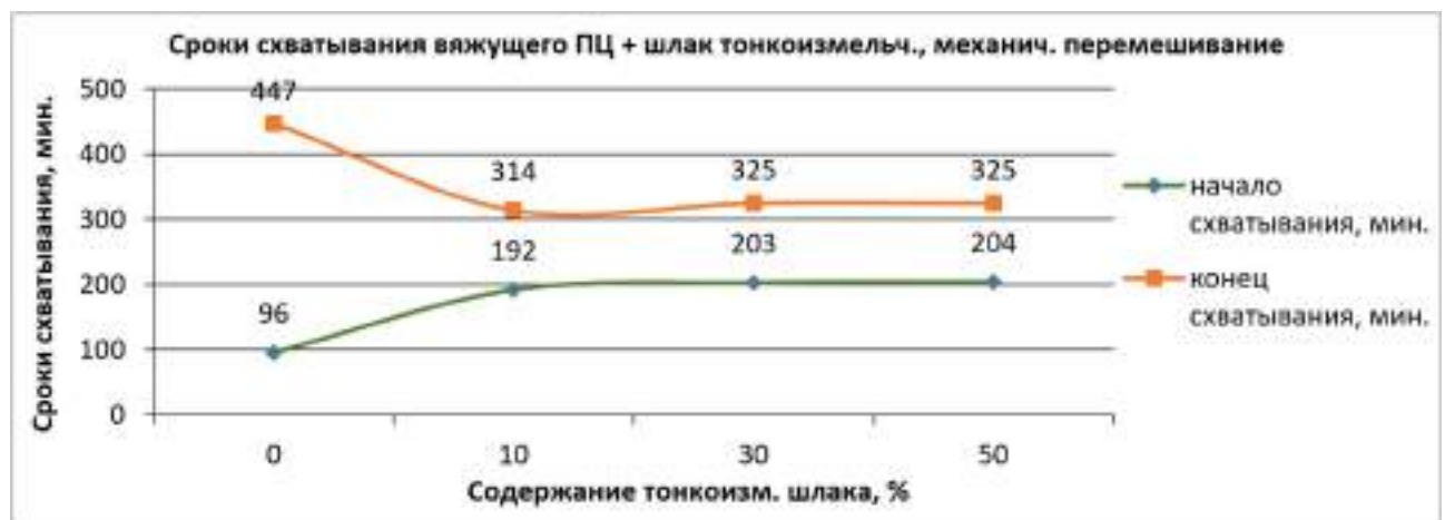
Рисунок 4 – Сроки схватывания вяжущего ЦЩВ-Пм механически перемешанного Ц + шлак измельченный
