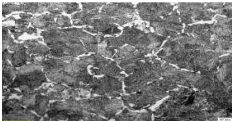
Рисунок 1 – Исходная структура стали (горячекатаное состояние)
