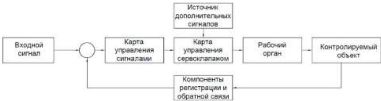
Рисунок 8 – Схема управления сервоклапаном
