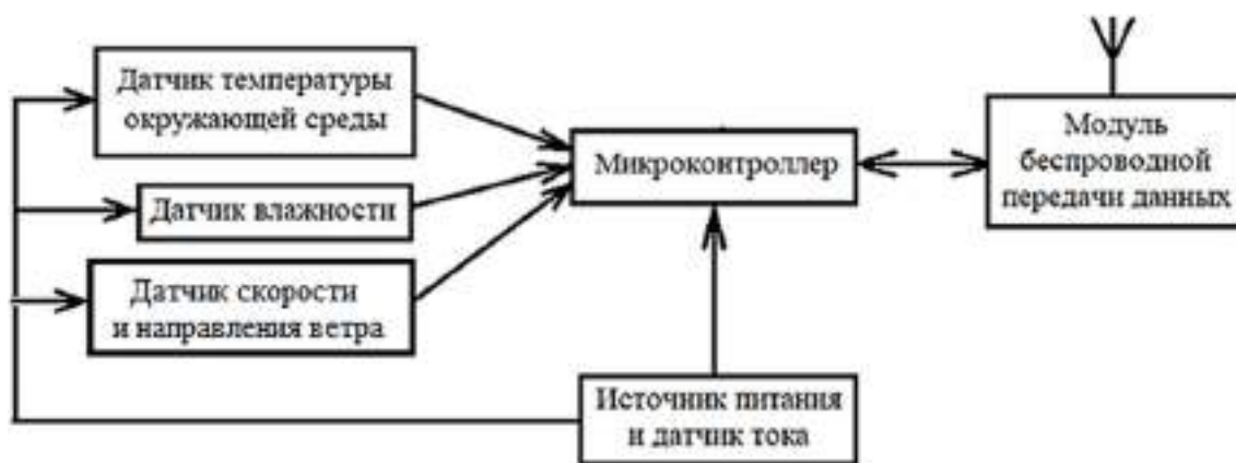
Рисунок 1 – Структурная схема подсистемы контроля начала обледенения
