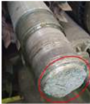
3-сурет – Шаршау салдарынан электр қозғалтқыштарының біліктерінің бұзылуы
