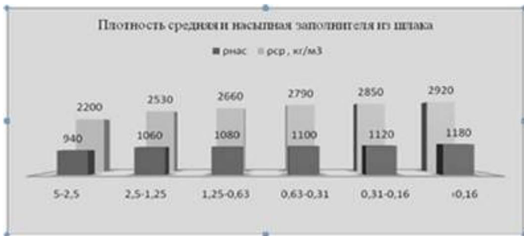
Рисунок 1 – Средняя и насыпная плотность заполнителя из шлака
