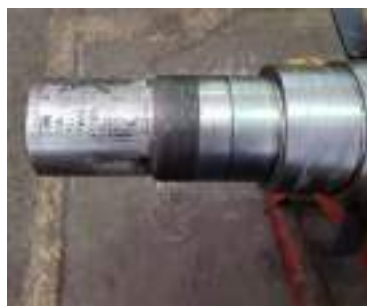
2-сурет – Тозуға байланысты электр қозғалтқыштарының біліктерінің бұзылуы
