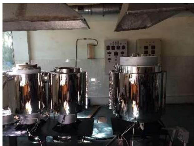
Промышленный прототип вакуум-дистилляционной установки
